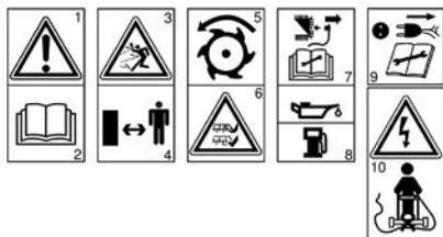
Rotační nástroje: Riziko useknutí končetin
